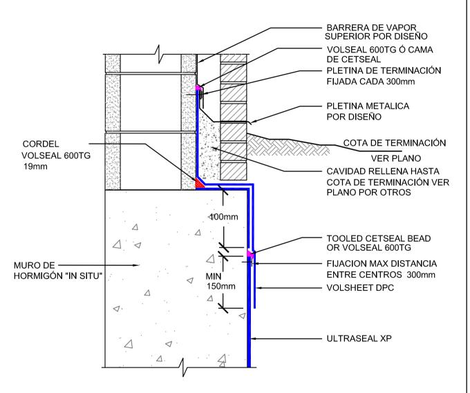
USE CETCO SEAMTAPE EN EL TRASDÓS EN LAS COSTURAS DE LOS SOLAPES DE ULTRASEAL XP INSTALAR ULTRASEAL XP CON EL GEOTEXTIL XP EN CONTACTO DIRECTO CON EL HORMIGÓN
