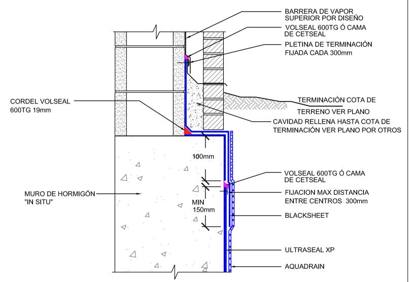
USE CETCO SEAMTAPE EN EL TRASDÓS EN LAS COSTURAS DE LOS SOLAPES DE ULTRASEAL XP INSTALAR ULTRASEAL XP CON EL GEOTEXTIL XP EN CONTACTO DIRECTO CON EL HORMIGÓN
