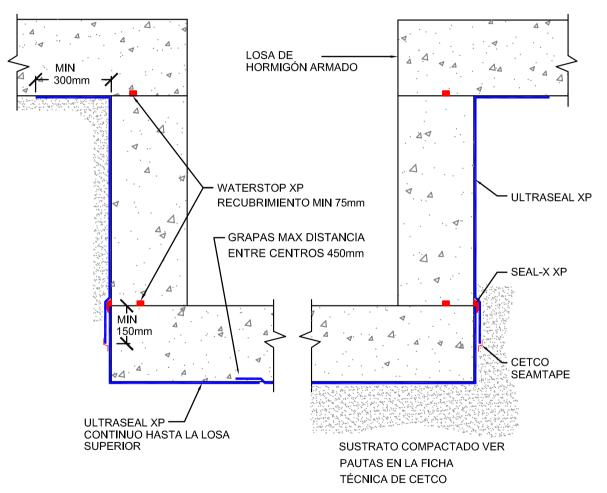
INSTALAR CETCO SEAMTAPE EN LAS COSTURAS DE LOS SOLAPES DE ULTRASEAL XP DEL TRASDÓS INSTALAR ULTRASEAL XP CON EL GEOTEXTIL XP DIRECTAMENTE EN CONTACTO CON EL HORMIGÓN
