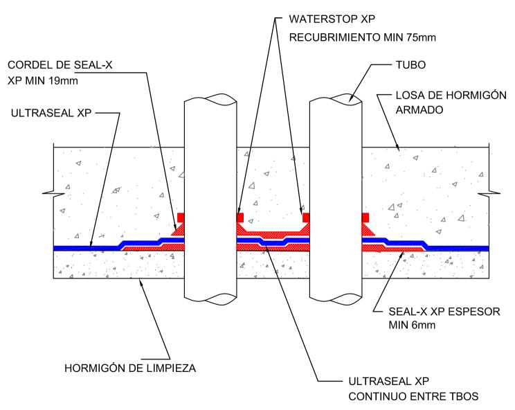
INSTALAR ULTRASEAL XP CON EL GEOTEXTIL XP EN CONTACTO DIRECTO CON EL HORMIGÓN
